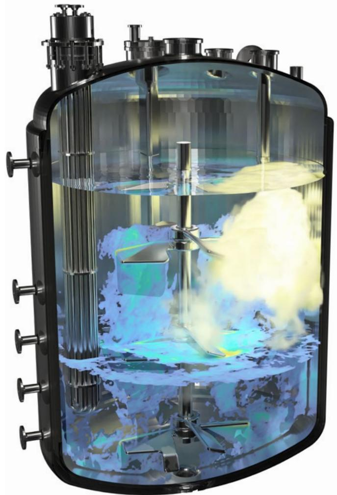
Ⓢ CFD-Simulation eines BE6300 mit 3-stufigen TAR/TAF-Rührsystem. Visualisierung der Strömungsgeschwindigkeit und Einleitung einer zweiten Substanz (gelb).
