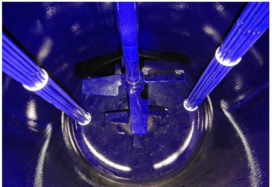
⌚ BE16000 mit zweistufigem TAF-Rührsystem und zwei PowerBaffle zur deutlichen Steigerung des Wärmestroms
