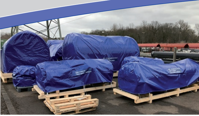
1: WePro ermöglicht die wetterfeste Lagerung verfahrenstechnischer Apparate / WePro allows weather-proofed storage of process engineering equipment
