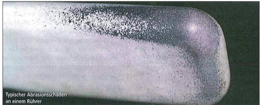
Typischer Abrasionsschaden an einem Rührer
