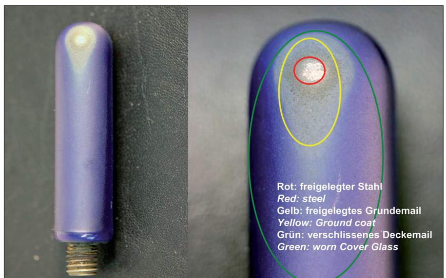
**Abbildung 5:** Verschlissene, angeströmte Seite des einen Probekörpers mit inhomogenem Emailabtrag. Der größte Emailabtrag findet am Beginn der Kuppe des Probekörpers statt.
