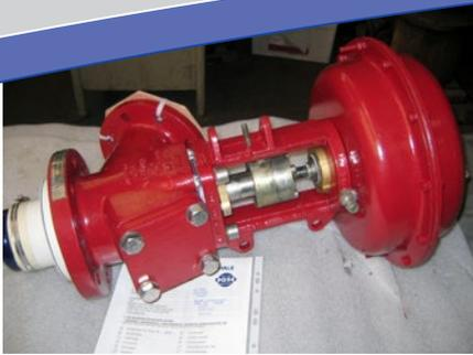
1: Aufgearbeitetes Bodenauslaufventil eines Fremdherstellers
