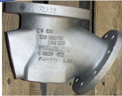
2: Ventilkörper eines Ventils eines Fremdherstellers vor dem Reemaillieren
