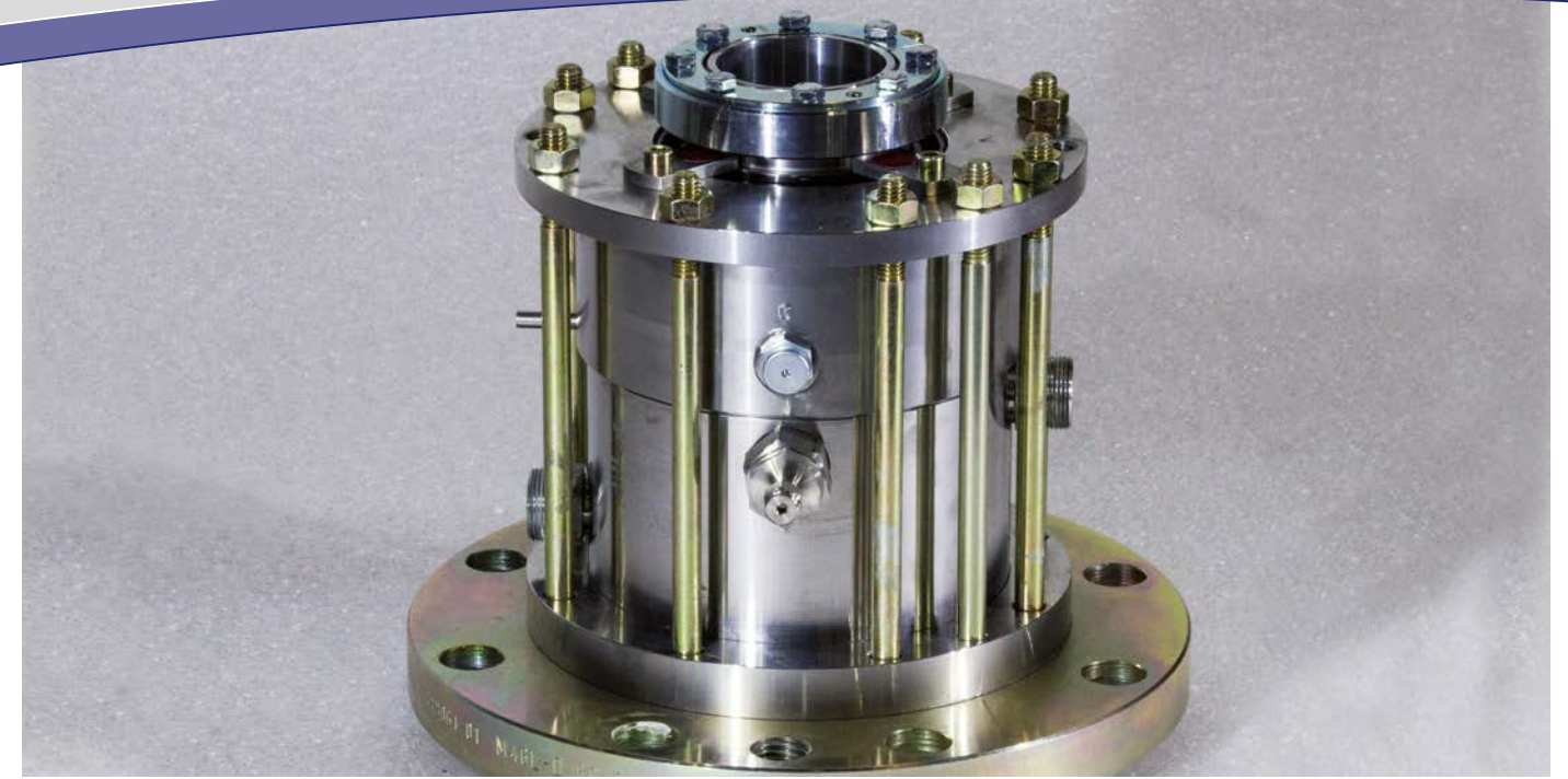
3: Durch THALETEC instandgesetzte Gleitringdichtung
