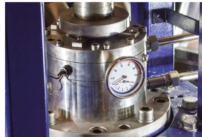
2: Rührbehälter mit instandgesetzter Gleitringdichtung
