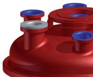
② 2: Reparaturschürze eingebaut / Repair sleeve assembled
