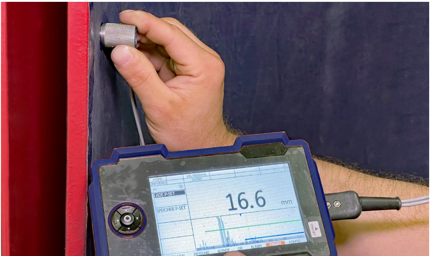
↑ Messen der Wandstärke eines emaillierten Apparates von der emaillierten Innenseite aus
