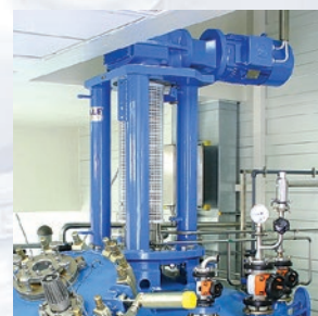
Rührwerksantrieb eines RWA BE 8 m 3 TRD 500 / 7,5 / 10 kW - SX im Praxiseinsatz
