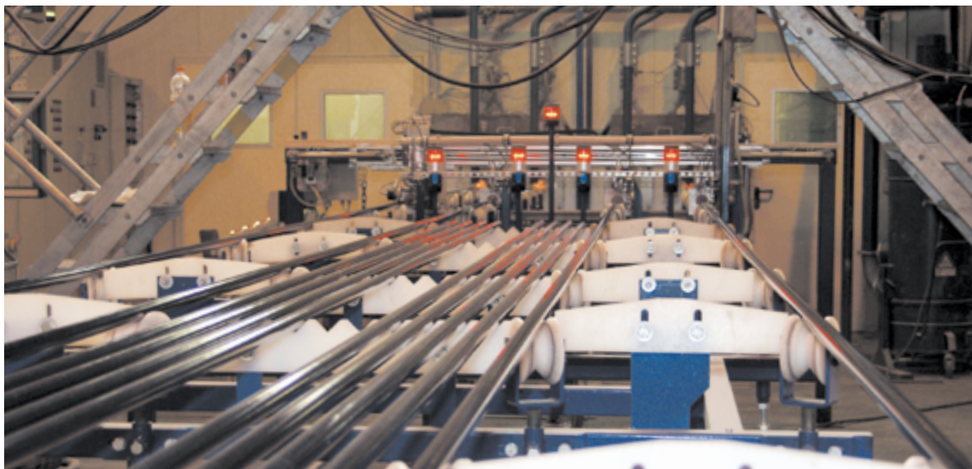
Vollautomatische Fertigungsstraße zur Herstellung emaillierter Rohre durch das trockenelektrostatische Auftragsverfahren
