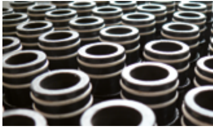
geschliffene SIC-Rohrenden mit doppelter O-Ring-Abdichtung
